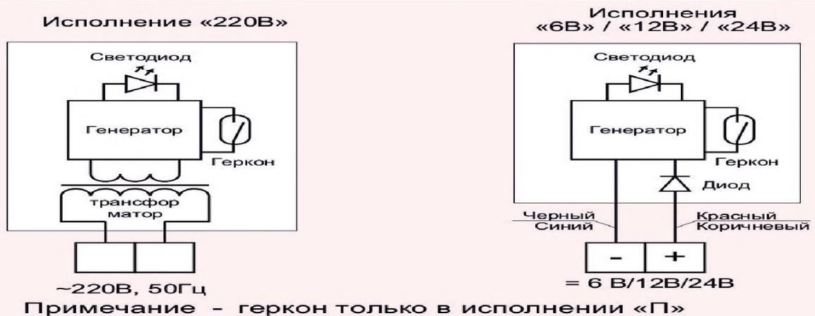
Рис. 2. Схемы соединений.
