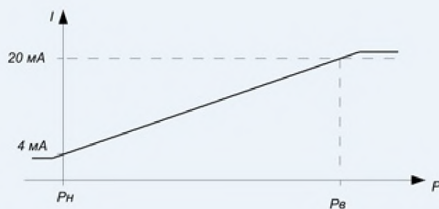
Рис. 3. График выходного сигнала датчика СЕНС ПД-4-20 мА
