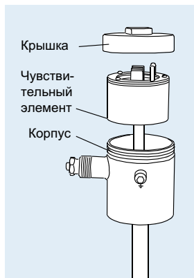
Рис. 3. Демонтаж чувствительного элемента
