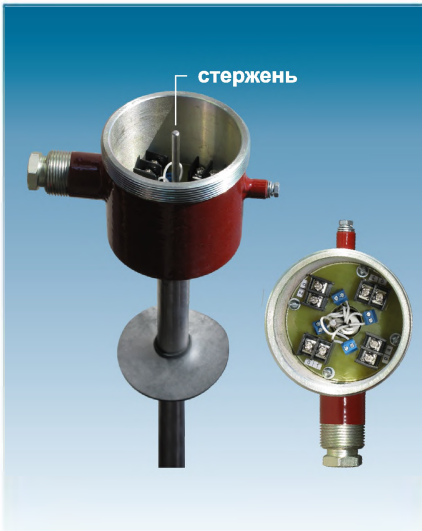
Рис. 1. ПМП-152. Внешний вид. На стержне крепятся платы герконов, которые можно передвигать для настройки уровней.
