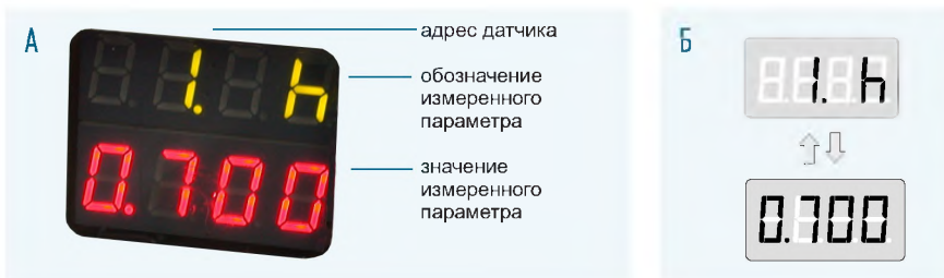
Рис. 2. А - структура дисплея с двумя строками; Б - отображение параметров дисплеем, имеющим одну строку.
