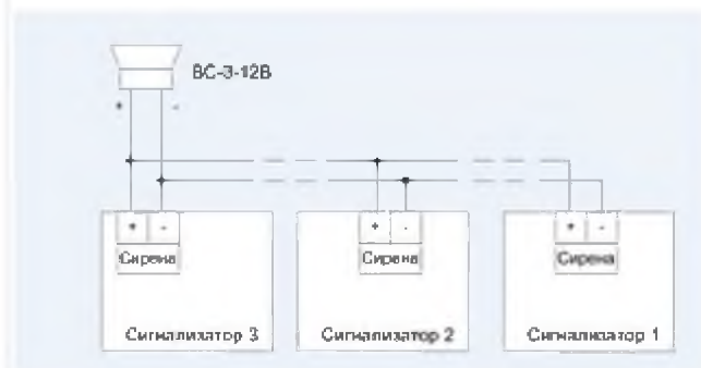
Рис.5. Схема соединения нескольких сигнализаторов МС-3-2Р-ГС, МС-3-2Р-ГС(ВА), МС-3-2Р-ГС-ВЗ на один сигнализатор ВС-3-12В.
